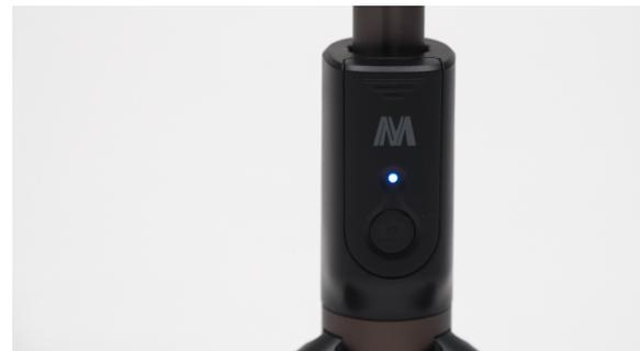
**6** Den Knopf am Gerät gedrückt halten, bis das blaue Licht blinkt. Via Bluetooth mit „WS-SQB641“ verbinden.
