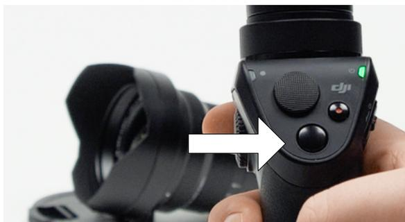
**11** Der unterste Knopf wechselt in den Fotomodus und löst ein Bild aus.
